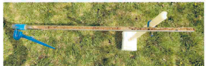
Abbildung des zum Einsatz kommenden „Pürckhauer“-Bohrstock
